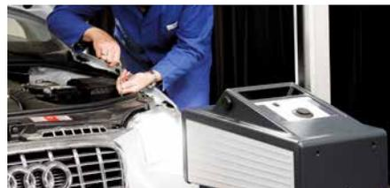
Die Scheinwerfereinstellung erfolgt über die von der Fahrzeugseite sichtbare Projektionsfläche. Anhand aufgedruckter Grenzlinien werden die Soll- und Istwerte verglichen und entsprechend justiert. Über einen Umlenkspiegel ist das Scheinwerferabbild auch von der Gerätevorderseite sichtbar.
