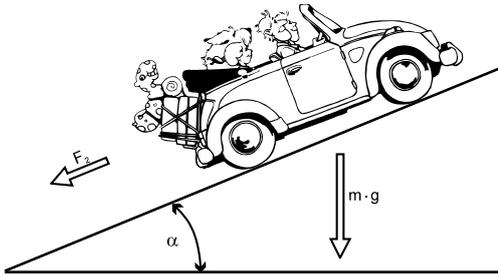
Berechnung der Zugkraft  $F_{st}$
