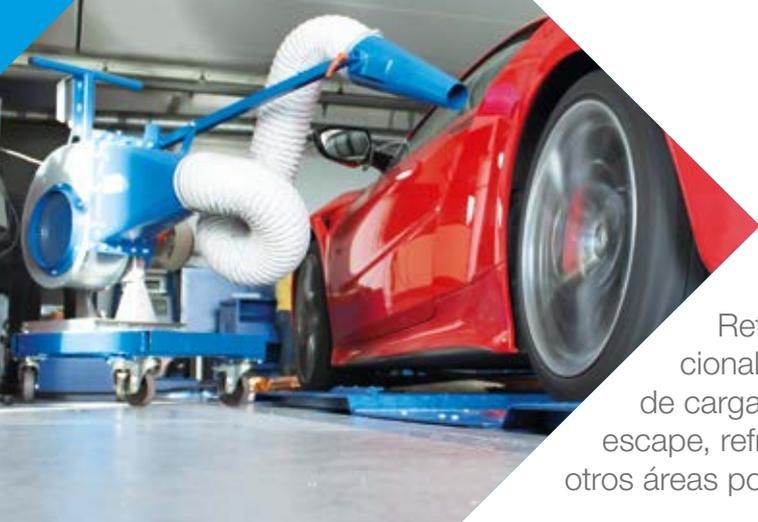
Refrigeración dirigida adicional de refrigeradores de aire de carga, colectores de gases de escape, refrigeradores de aceite y otros áreas por Ventilador adicional
